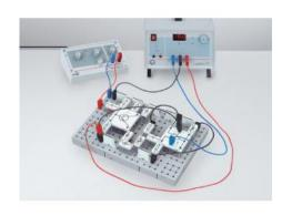
Dans l'expérience P4.1.7.2, on démontre la transmission optique des signaux électriques dun générateur de fonctions vers un haut-parleur.
