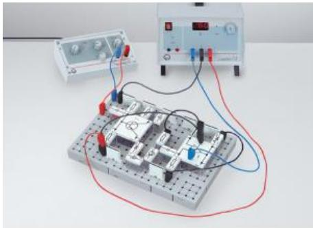
Dans l'expérience P4.1.7.2, on démontre la transmission optique des signaux électriques d'un générateur de fonctions vers un haut-parleur.
