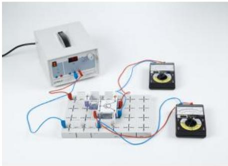
Dans l'expérience P4.1.6.2, un transistor bipolaire est utilisé comme interrupteur.
