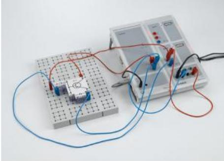
Dans l'expérience P4.1.5.4, on étudie les propriétés d'un transistor npn à l'appui de ses caractéristiques.
