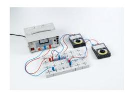
Dans l'expérience P4.1.4.2, on démontre lutilisation dune diode Zener comme protection contre les surtensions. Tant que la tension appliquée reste inférieure à la tension davalanche UZ de la diode Zener, cette dernière agit comme un isolant et la tension U reste non influencée.
