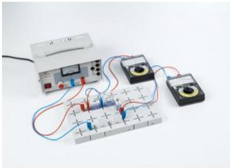
Dans l'expérience P4.1.4.2, on démontre l'utilisation d'une diode Zener comme protection contre les surtensions. Tant que la tension appliquée reste inférieure à la tension de avalanche  $U_Z$  de la diode Zener, cette dernière agit comme un isolant et la tension  $U$  reste non influencée.
