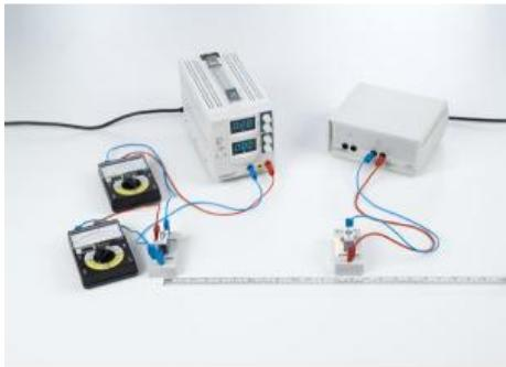
La caractéristique d'une photorésistance (LDR résistance dépendant de la lumière) CdS fait l'objet de l'expérience P4.1.2.4 : sa résistance varie suivant la luminosité entre environ 100  $\Omega$  et 10 M $\Omega$ .
