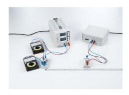
La caractéristique dune photorésistance (LDR résistance de dépendant de la lumière) CdS fait lobjet de l'expérience P4.1.2.4 : sa résistance varie suivant la luminosité entre environ 100 ù et 10 Mù.
