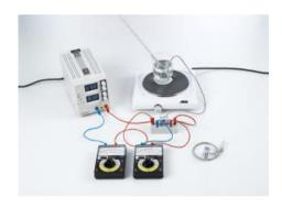
Dans l'expérience P4.1.2.3, on mesure les caractéristiques de température de deux thermistors: une résistance CTN et une résistance CTP.
