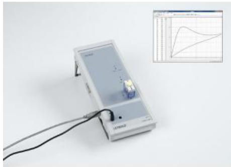
Au cours de l'expérience P4.1.2.1, on utilise le système CASSY pour relever la caractéristique courant-tension d'une lampe à incandescence.
