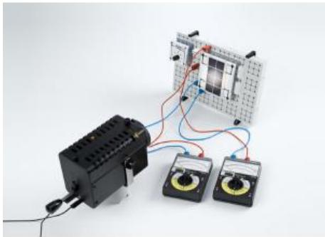
Au cours de l'expérience P4.1.1.3, on trace les caractéristiques courant-tension d'une pile solaire pour différents éclairages.
