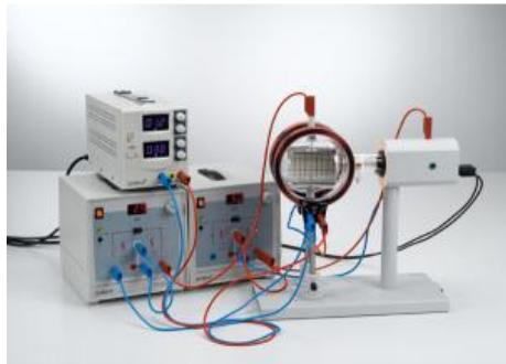
Dans l'expérience P3.8.5.2, on monte un filtre de vitesses (filtre de Wien) avec un champ électrique et un champ magnétique croisés, ce qui permet entre autres de déterminer la charge spécifique des électrons de manière plus précise.
