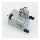
L'oscillateur Gunn sert à la production de puissance hyperfréquence. Il est démontable et se compose des éléments suivants : Module avec diode Gunn, env. 27 mm de long Paroi arrière du boîtier Diaphragme avec ouverture de 8 mm de diamètre Adaptateur de guide d'ondes, env. 32 mm de long Module avec diode Gunn en aluminium, à éléments de fermeture rapides.
