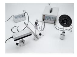
Lobjet de l'expérience P3.7.2.2 est la transmission des signaux de fréquence acoustique avec des ondes décimétriques modulées en amplitude.
