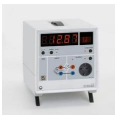
Pour la mesure et l'affichage de la tension efficace U et du courant efficace I pour des tensions et courants d'allure quelconque, de la puissance active P ainsi que de l'intégrale temporelle de P(t) (travail), U (t) (pointe de tension) et I(t) (charge).
