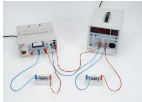
**P3.6.6.3 Comparaison quantitative entre la puissance du courant continu et celle du courant alternatif avec une ampoule incandescente**
