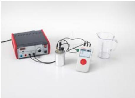
Dans l'expérience P3.6.6.1, on détermine la puissance électrique d'un thermoplongeur pour de petites tensions à partir de la chaleur cédée par effet Joule par unité de temps.
