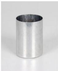
Récipient pour l'étude de l'énergie thermique (par ex. par la méthode des mélanges). S'utilise avec le récipient isolant ( 38451 ).
