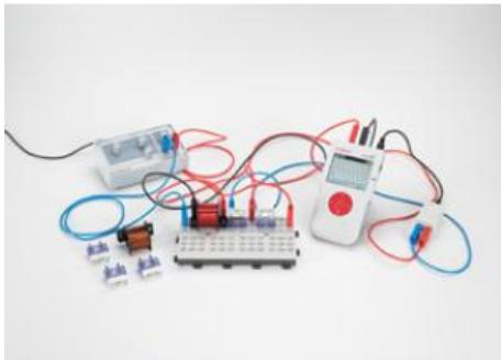
**P3.6.3.6 Détermination de la résistance en courant alternatif dans des circuits électriques**
