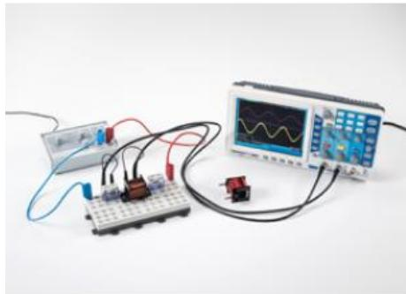
Dans l'expérience P3.6.3.1, on combine une capacité C avec une résistance R, dans l'expérience P3.6.3.2, on combine une inductance L avec une résistance R.
