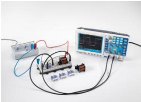
**P3.6.2.1 Mesure de l'allure du courant dans une bobine à l'enclenchement**
