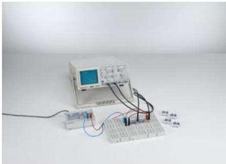
Dans l'expérience P3.6.1.1, le générateur de fonctions produit des signaux rectangulaires périodiques qui représentent l'enclenchement et la coupure d'un courant continu. Les signaux rectangulaires sont représentés avec le canal 1 de l'oscilloscope, la tension ou le courant du condensateur sont représentés avec le canal 2. On détermine la constante de temps
