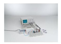
Dans l'expérience P3.6.1.1, le générateur de fonctions produit des signaux rectangulaires périodiques qui représentent l'enclenchement et la coupure d'un courant continu.
