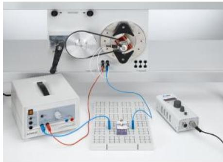
L'expérience P3.5.3.4 consiste à synchroniser manuellement le rotor bobiné du moteur synchrone à courant alternatif avec la fréquence de la tension appliquée, afin qu'il fonctionne de manière autonome par la suite.
