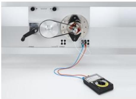
L'expérience P3.5.2.2 démontre l'utilisation d'un commutateur pour redresser la tension alternative produite dans le rotor d'une génératrice à pôles extérieurs.
