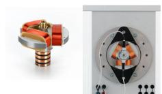
Sur noyaux de fer en paquets de toles feuilletées sans courant parasite ; avec coussinet de pivotement, poulie et tambour d'enroulement.
