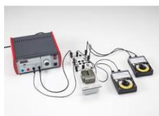
L'objet de l'expérience P3.4.5.1 est de mesurer la conversion de la tension d'un transformateur à vide et la conversion du courant d'un transformateur en court-circuit.
