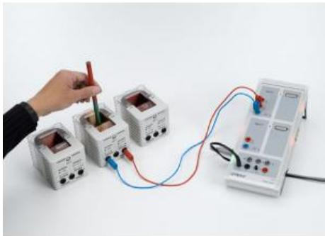
L'expérience P3.4.1.1 consiste à produire un saut de tension en plaçant manuellement un barreau magnétique dans une bobine sans fer, ou en le retirant de la bobine.
