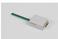
Pour la mesure de la densité du flux magnétique de petits champs en direction axiale avec CASSY ( 524013 , 524006 , 524005W , 524018 ) ou l'instrument de mesure universel Physique ( 531835 ). La sonde sert par exemple à mesurer la valeur et la direction du champ magnétique terrestre (40 ... 60 $\mu T$ ) ou à mesurer le champ magnétique d'un conducteur traversé par un courant continu ou alternatif (Biot et Savart).
