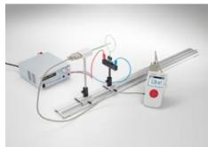
Dans l'expérience P3.3.4.1, on mesure le champ magnétique d'un conducteur droit et long pour différentes intensités  $I$  du courant, en fonction de la distance  $r$  au conducteur.
