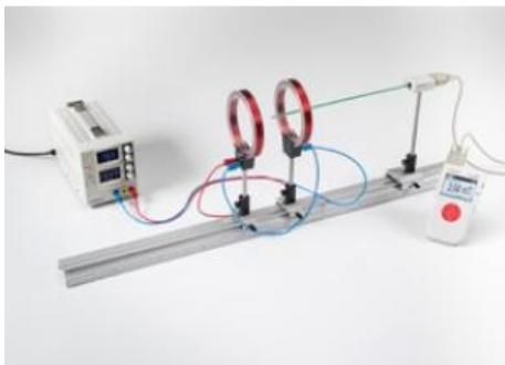
**P3.3.4.3 Mesure du champ magnétique sur une paire de bobines dans un dispositif de Helmholtz**
