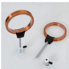
Pour la génération d'un champ magnétique homogène, par ex. pour des expériences avec les tubes de démonstration LD.
