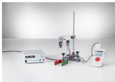
Dans l'expérience P3.3.3.1, les boucles conductrices se trouvent dans le champ magnétique dun aimant en fer à cheval.
