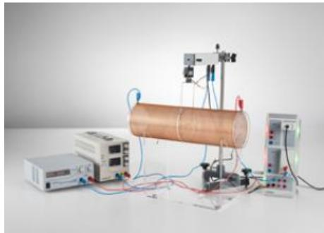
**P3.3.3.3 Mesure de la force sur un conducteur parcouru par un courant**
