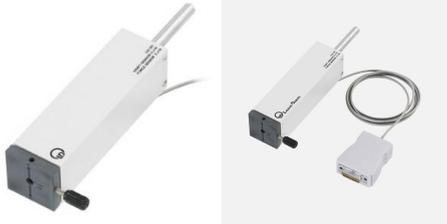
Pour mesurer des forces (par ex. électrostatiques) de  $\pm 1$ N avec CASSY ( 524013 , 524006 , 524005W , 524018 ) ou l'instrument de mesure universel Physique ( 531835 ). Avec deux lames souples à quatre jauges extensométriques montées en pont.
