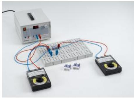
L'expérience P3.2.4.2 consiste à déterminer la résistance interne d'un voltmètre en mesurant le courant qui le parcourt.
