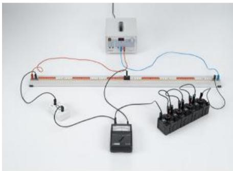
Dans l'expérience P3.2.3.4, une tension  $U$  est appliquée à un fil de mesure de section constante et de 1 m de long. Les extrémités du fil sont reliées à une résistance inconnue  $R_x$  et à une résistance variable  $R$  placée derrière, parfaitement connue.
