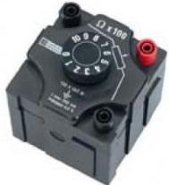
Résistance de mesure en montage potentiométrique, réglable par commutateur rotatif ; possibilité d'assemblage d'un jeu de décades à plusieurs niveaux en association avec d'autres décades de résistances.
