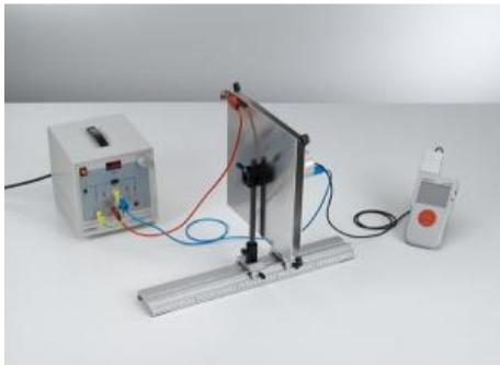
L'expérience P3.1.7.4 se consacre à la détermination de la dépendance du potentiel du champ électrique  $E$  de la tension donnée  $U$  et de la distance entre les plaques  $d$ .
