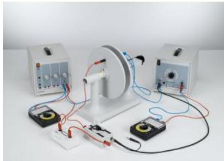
L'expérience P3.1.7.3 consiste à mesurer avec précision la capacité C d'un condensateur à plaques en fonction de la distance d entre les plaques.
