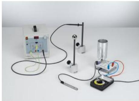
L'expérience P3.1.6.1 consiste à déterminer la capacité d'une sphère dans un espace libre, en électrisant la sphère avec une haute tension  $U$  connue et en mesurant sa charge  $Q$  avec un amplificateur électromètre branché en coulombmètre.
