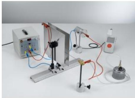
**P3.1.3.3 Mesure du potentiel dans les condensateurs à plaques**
