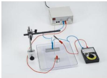
L'expérience P3.1.3.2 consiste à mesurer les lignes équipotentielles de différents corps électrisés. Pour ce faire, on applique une tension sur des paires de électrodes dans une cuve électrolytique remplie deau distillée.
