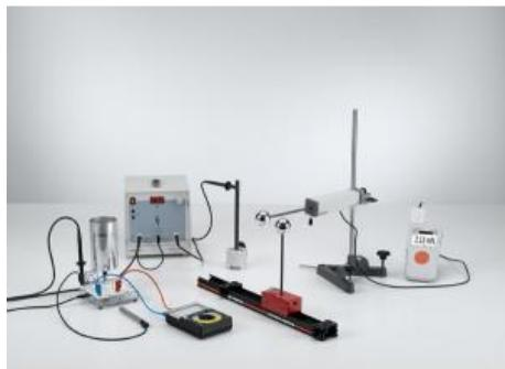
Dans l'expérience P3.1.2.2, le capteur de force est branché à un instrument de mesure qui indique directement la force.
