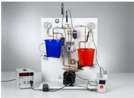
Dans l'expérience P2.6.3.3, on suit les transformations dénergie dans la pompe à chaleur grâce à un diagramme de Mollier, dans lequel la pression  $p$  est portée en fonction de lenthalpie spécifique  $h$  de lagent réfrigérant. Les enthalpies correspondantes  $h_a$ ,  $h_b$ ,  $h_e$  et  $h_f$  sont déterminées aussi bien daprès les pressions  $p_1$  et  $p_2$  dans lévaporateur et le liquéfacteur que daprès les températures  $T_a$ ,  $T_b$ ,  $T_e$  et  $T_f$  du réfrigérant.
