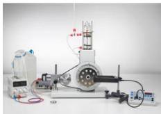
Pour déterminer le travail de frottement WF, on mesure au cours de l'expérience P2.6.2.1 lélévation de température TF de leau de refroidissement, pendant que le moteur à air chaud a sa culasse ouverte et est entraîné par un moteur électrique.
