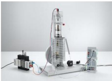
**P2.6.2.4 Diagramme pV du moteur à air chaud comme moteur thermique**
