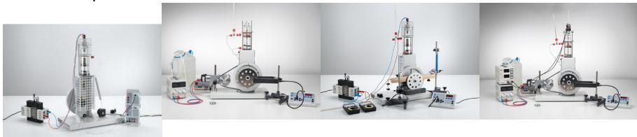
Au cours de l'expérience P2.6.2.4, on trace le diagramme pV du moteur à air chaud en tant que moteur thermique à l'aide de l'interface CASSY : un capteur de pression mesure la pression  $p$  dans le cylindre en fonction du temps  $t$  et un capteur de déplacement enregistre la position  $s$  du piston moteur à partir de laquelle le volume  $V$  enfermé est calculé.
