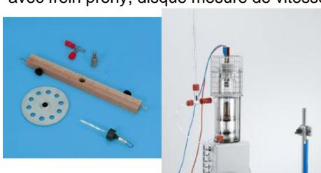
Pour la détermination quantitative du bilan des puissances, du freinage mécanique, de la mesure sans contact de la vitesse de rotation, de la mesure du débit et de la température du flux d'eau de refroidissement ainsi que pour la compensation électrique de la puissance frigorifique.
