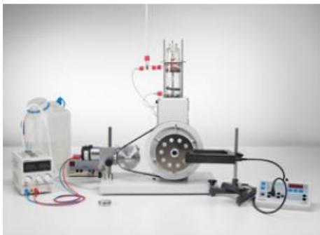
Pour déterminer le travail de frottement WF, on mesure au cours de l'expérience P2.6.2.1 lélévation de température TF de leau de refroidissement, pendant que le moteur à air chaud a sa culasse ouverte et est entraîné par un moteur électrique.
