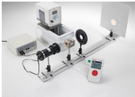
**P2.4.3.2 Etude d'un mélange liquide / gaz au point critique - Mesure avec Mobile-CASSY**
