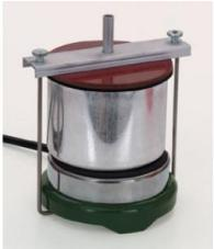
Produit la vapeur nécessaire, par exemple, pour les expériences de dilatation thermique.
