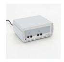
Spécialement conçu pour l'alimentation du carter de lampe (450 60) et des lampes Science Kit Advanced (459 032 , 459 046 , 459 092); protégé contre les surcharges.
