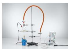
Durant l'expérience P2.4.2.1, on trace la courbe de la pression de vapeur de l'eau en dessous du point débullition normal à laide de l'interface CASSY.
