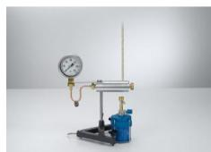
Dans l'expérience P2.4.2.2, on utilise l'appareil à vapeur sous haute pression pour des mesures de pressions jusqu'à 50 bars.
