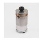
Pour étudier l'échauffement en fonction du travail de frottement ou de l'énergie électrique et déterminer la capacité thermique (massique).
