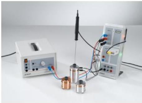
Au cours de la expérience P2.3.4.3, il s'agit de procéder à la mise en évidence expérimentale de l'équivalence entre l'énergie électrique Eel et l'énergie thermique Eth. Pour ce faire, l'énergie électrique Eel fournie dans l'expérience dans le filament chauffant (ou spirale chauffante) est convertie en chaleur Eth.
