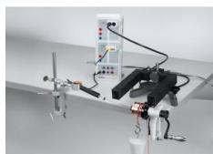
Dans l'expérience P2.3.3.1, on met en évidence l'équivalence entre énergie mécanique et énergie thermique: à laide d'une manivelle, on fait tourner différents récipients calorimétriques sur leurs axes, les faisant ainsi chauffer par frottement contre une corde en nylon.
