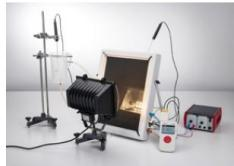
Au cours de l'expérience P2.2.2.1, on détermine la quantité dénergie Q cédée par unité de temps daprès lélévation de température de leau qui circule puis on estime lénergie rayonnante absorbée par unité de temps daprès la puissance de la lampe et la distance qui la sépare de labsorbeur.
