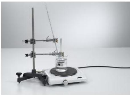
Au cours de l'expérience P2.1.2.1, on détermine le coefficient de dilatation cubique de l'eau et de l'éthanol à l'aide d'un dilatomètre volumétrique en verre.
