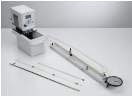
Pour l'expérience P2.1.1.3, on utilise un thermostat à circulation pour chauffer leau qui traverse les différents tubes.
