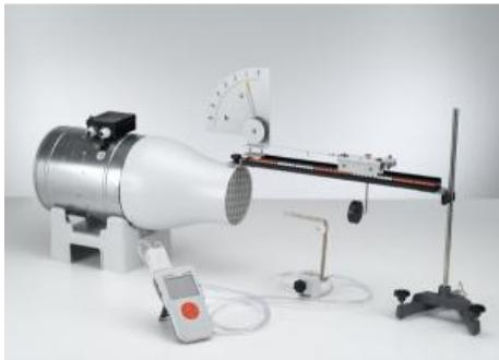
**P1.8.6.4 Résistance de l'air en fonction de la vitesse du vent et de la forme de l'objet**
