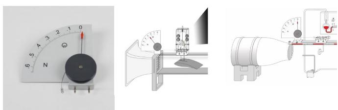
Dynamomètre de précision pour la mesure de la résistance à l'écoulement de l'air dans la veine d'essais pour l'aérodynamique ( 37306 ) ou dans le tunnel aérodynamique ( 37312 ).
