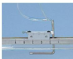
Pour mesurer la pression statique, la pression totale et la pression dynamique d'un gaz en écoulement.
