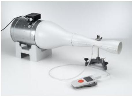
**P1.8.5.4 Pression statique et détermination de l'écoulement volumétrique avec un tube de Venturi**
