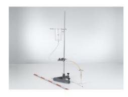
Pour un fluide newtonien (écoulement laminaire, par ex.), la loi de Hagen-Poiseuille décrit la relation entre le débit volumique J et la différence de pression :
